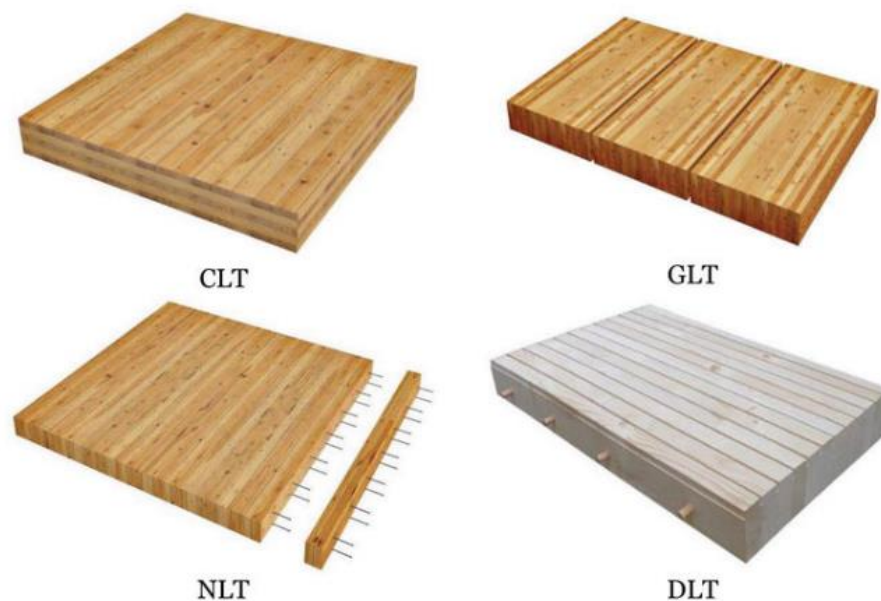
Mynd 2 - Afurðir timburs notaðar í byggingariðnaði (Gong, 2019).
