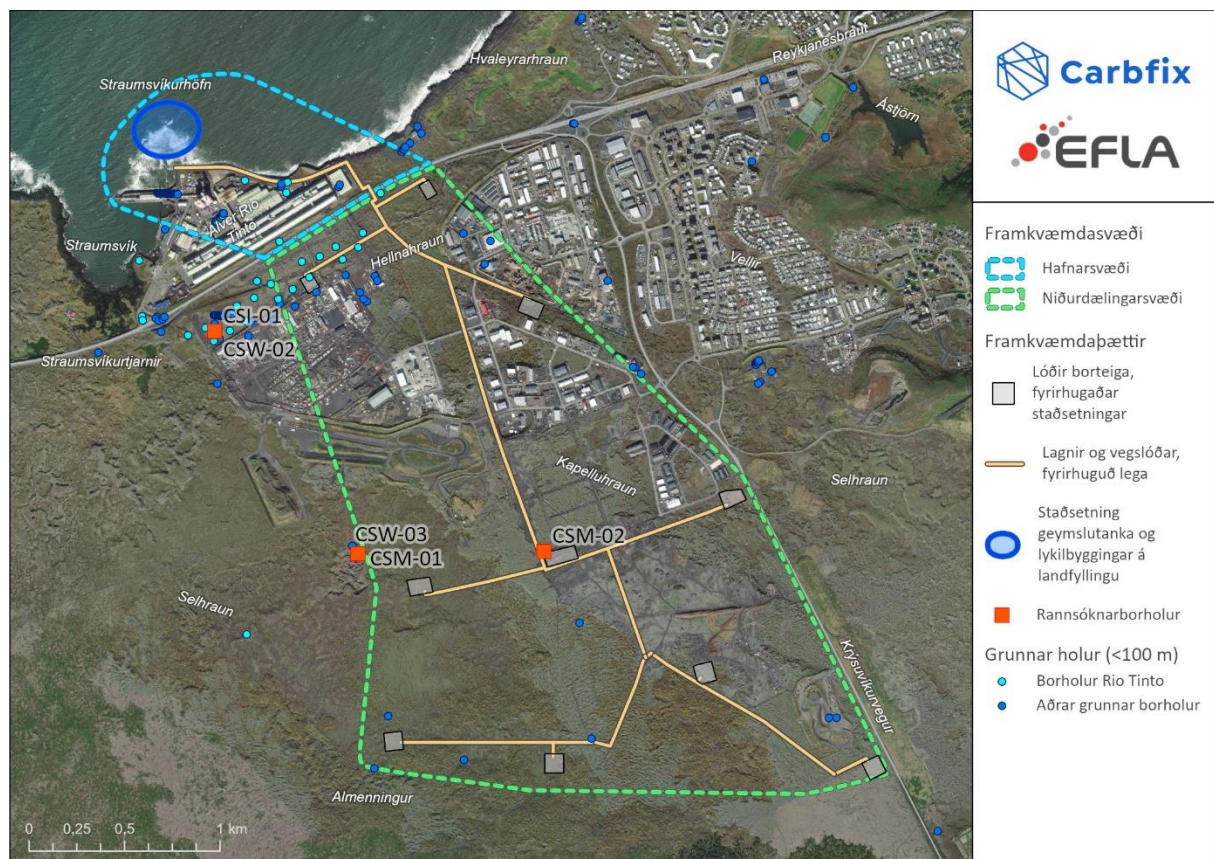
MYND 8.18 Staðsetningar rannsóknarhola sem boraðar voru til að afla upplýsinga um geymslugeymi á framkvæmdarsvæði Coda Terminal (niðurdælingarsvæði táknað með grænni punktalínu og hafnarsvæði táknað með blárrí punktalínu). Lagnaleiðir og fyrirhugaðar staðsetningar borteiga eru jafnframt sýndar auk staðsetningar geymslutanka (blár hringur). Byggt á gögnum frá Orkustofnun. Kort: EFLA, 2024.
