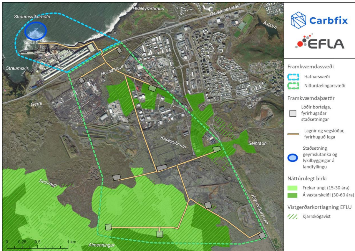
MYND 8.35 Birkiskógur við framkvæmdasvæðið sem býr yfir sérstakri vernd samkvæmt 61. gr. laga um náttúruvernd nr. 60/2013. Framkvæmdasvæði Coda Terminal (niðurdælingarsvæði táknað með grænni punktalínu og hafnarsvæði táknað með blárrí punktalínu) er jafnframt sýnt ásamt lagnaleiðum og fyrirhuguðum staðsetningum borteiga auk staðsetninga geymslutanka (blár hringur). Kort: EFLA, 2024. Byggt á gögnum frá Skógræktinni (nú Landi og Skógi).
