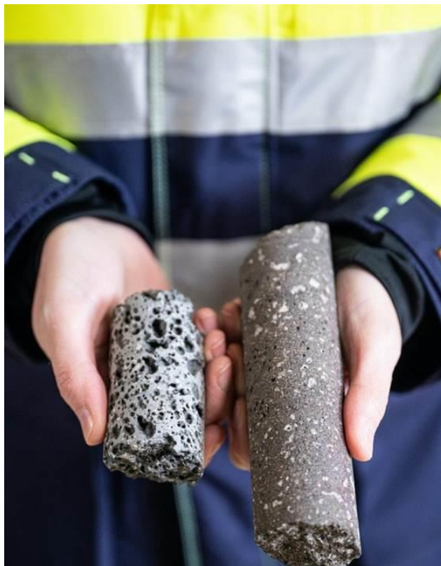
MYND 2.5 Dæmi um basaltberg þar sem engar útfellingar steinda hafa átt sér stað (vinstra megin) og basaltberg þar sem steindir á borð við kalsít (kalsíumkarbónat) hafa fallið út í sprungum og holrýmum líkt og gerist við niðurdælingu \text{CO}_2 með Carbfix aðferðinni. Mynd: Carbfix.
