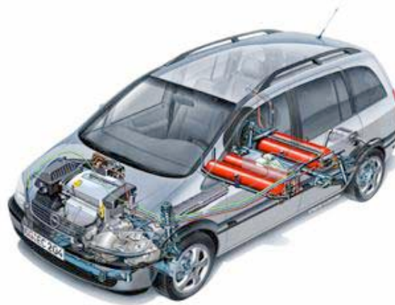
Mynd 7. Yfirlitsmynd af tæknibúnaði e.monovalent metanbifreiðar (NGVA, 2007).
