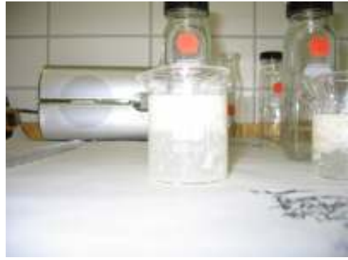
Mynd 10. Blöndun fjölliða (katjónískar) K1912 í slammi. Þurrefnið skildist frá og settist efst í glasinu.
