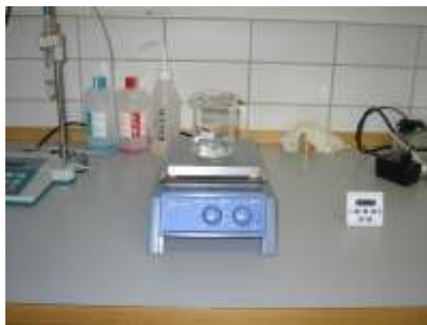
Mynd 8. Stilling sýrustigs kranavatns. Sýrustigið var stillt með einum dropa af brennisteinssýru.
