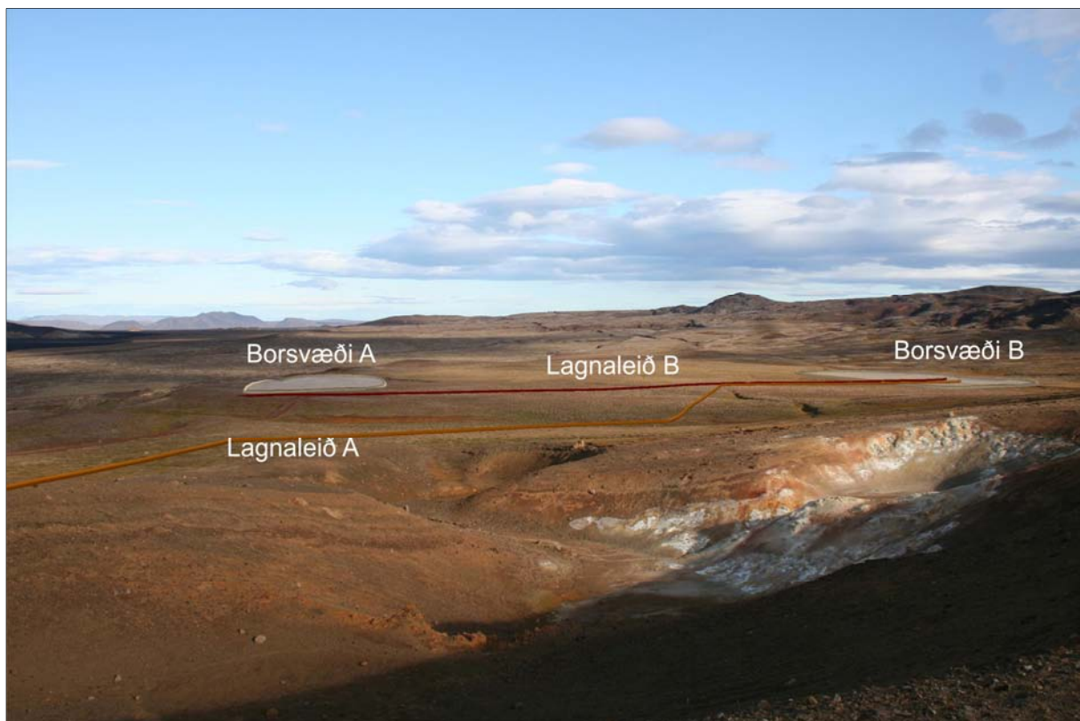
Mynd 5.5 Ljósmynd tekin af norðurbrún Vítis. Á myndina hafa fyrirhuguð borsvæði verið sett inn og mögulegar lagnaleiðir frá þeim.
