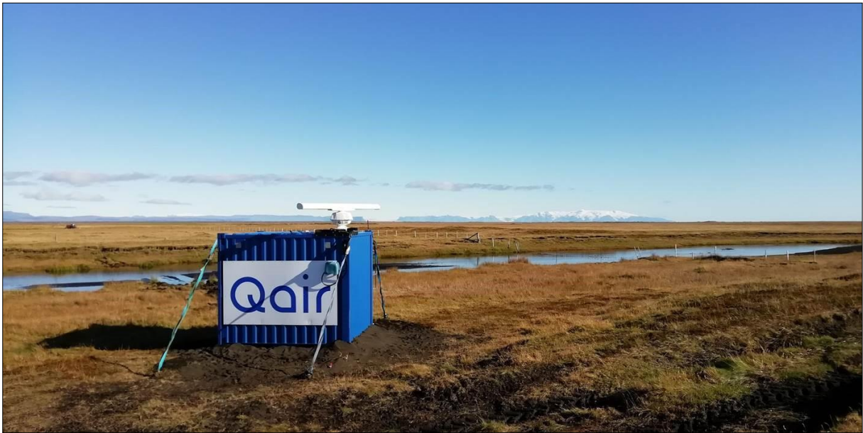
Mynd 5.6 Ratsjá uppsett í lárétrri stillingu á fyrirhuguðu framkvæmdasvæði.
