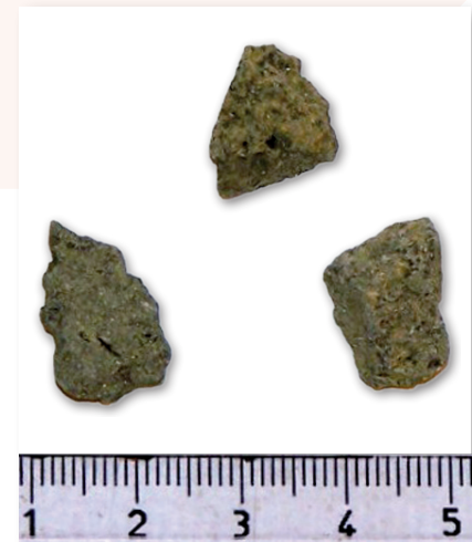
Blöðrótt basaltkorn: Efsta kornið er mest blöðrótt, síðan það til hægri en minnst kornið til vinstri.
