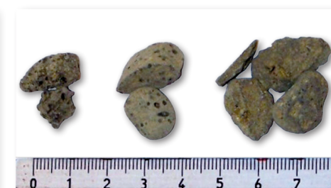
Mynd 4. Sýnir mun á basaltgleri (vinstri), blöðróttu (miðjunni) og þéttu (hægra megin) basalti.
