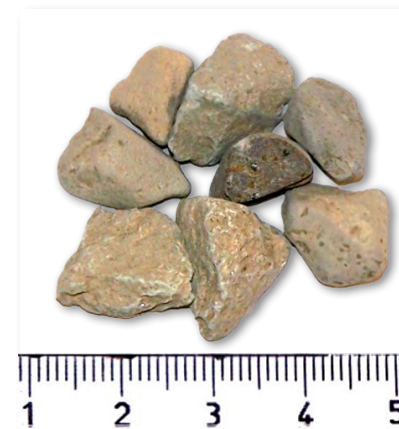
Líparít korn og setberg. Ávöl korn setbergsins sjást vel.
