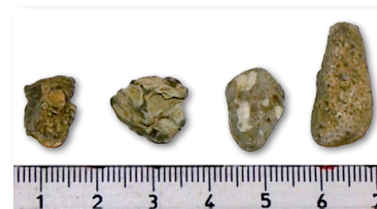
Líparít, gjall, holufylling og setberg.
