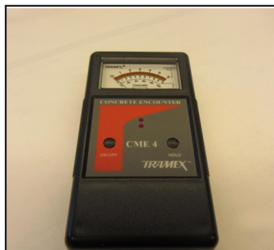
Mynd 2. Dæmigerður snerti-rakaskynjari fyrir yfirborðsmat
