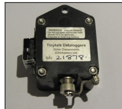
Mynd 4. Mælisynjari til mælinga á loft-hita og loftraka (aflestur í töflu)
