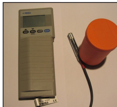
Mynd 3. HR-mælibúnaður fyrir raka í steypu
