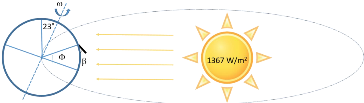
Mynd 9: Inngeislun sólar á hallandi flöt ræðst af breiddargráðu ( \Phi ), hvernig jörðin snýr gagnvart sólu (ræðst af tíma dags og árstíð) og halla flatar ( \beta ) frá láréttnu.
