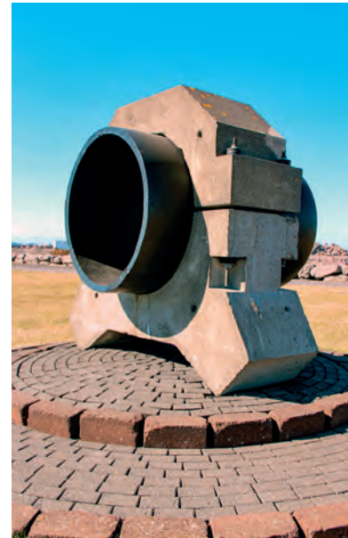
Fyrir utan stöðina í Klettagörðum er sýnishorn af hinu 5,5 kílómetra útrásarröri ásamt sökkli.
