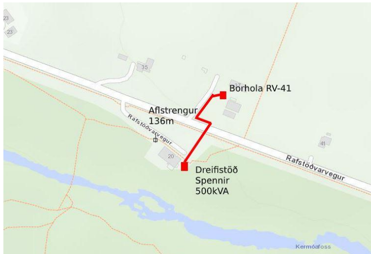
Mynd 29 - Staðsetning dreifistöðvar og lengd aflstrengs
