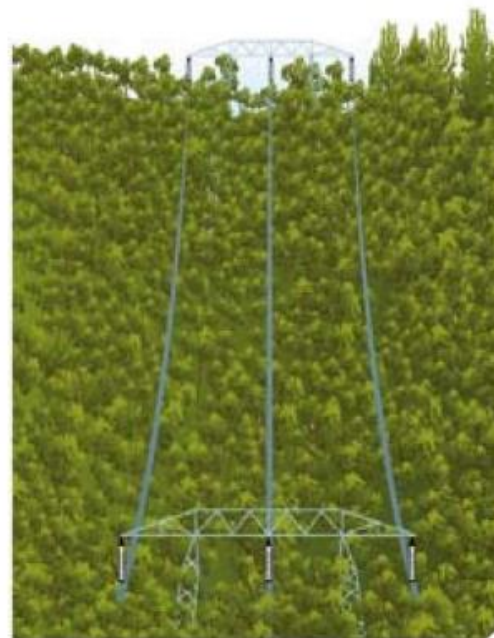
Dæmi um ólöglega hæð og fjarlægð trjáa frá línur
