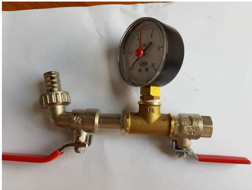
Mynd A.1: Þrýstingsmælir
