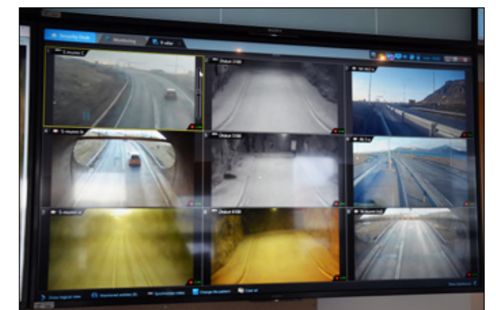
Í vaktstöð Vegagerðarinnar í Reykjavík er fylgst með myndavélum í Hvalfjarðargöngum. Tölvuhugbúnaður lætur vita ef bíll stansar á akbrautinni og þá er hægt að sjá myndir frá þeim stað.
