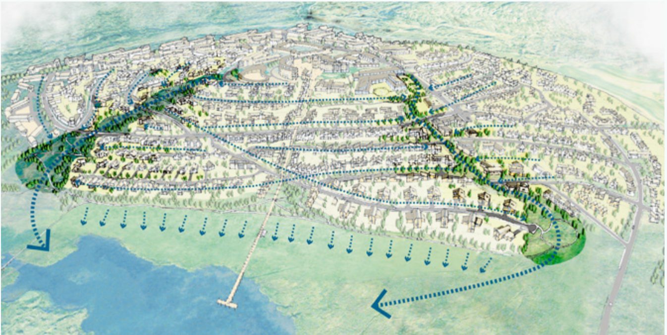
Mynd 15 Bláar örvar gefa til kynna hvernig ofanvatnslausnum er beitt í hverfinu í heild sinni. Þær eru sýnilegar í götum, grænum geirum og göngustíg sem liggur meðfram vatninu. Hlutverk hans er meðal annars að hindra að ofanvatn berist óhreinsað í Urriðavatnið í asahláku eða áköfum regnskúrum (Mynd úr rammaskipulagi Urriðaholts).
