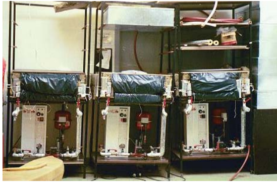
Mynd 3.1 Hringrásarkerfin þrjú. Undir einangruðum álkössum er stjórnbúnaðurinn.
