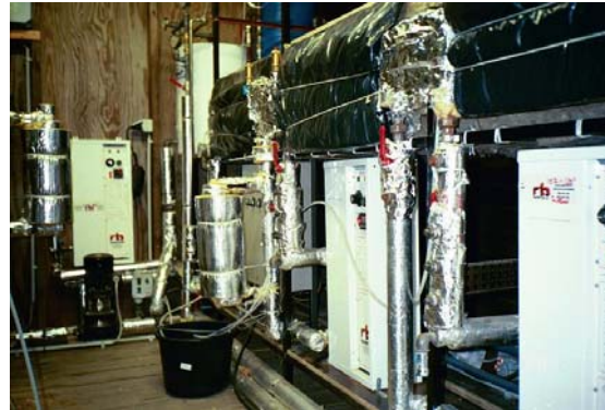
Mynd 3.4 Rásir með upphituðu og afloftuðu ferskvatni
