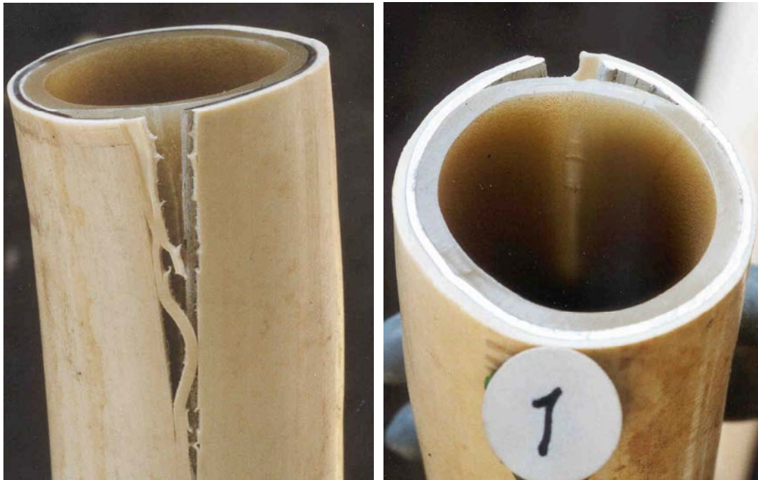
Rör sem sprakk. Efst er áður en það er skorið sundur. Á myndinni til vinstri sést vel hvernig álið og ytra plastlagið hefur rifnað. Á myndinni til hægri sést að innra plastlagið er að gefa sig, greina má smá göt í því sem lekur út um.
