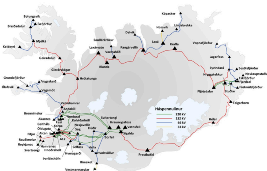
Mynd 1.1 Flutningskerfi raforku 2010. Heimild:Landsnet
