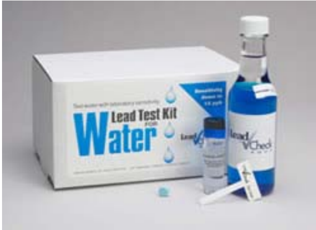
Mynd 7-2: Myndin sýnir LeadCheck® Aqua blýgreiningarsettið og greiningarborða sem sýnir merki um blýmengun. Innihald flöskunnar vinstra megin á myndinni er sýni sem búið er að meðhöndla með þeim efnum sem fylgja settinu. Tæri vökvinn efst er svokölluð burðarlausn (e: carrier solution).
