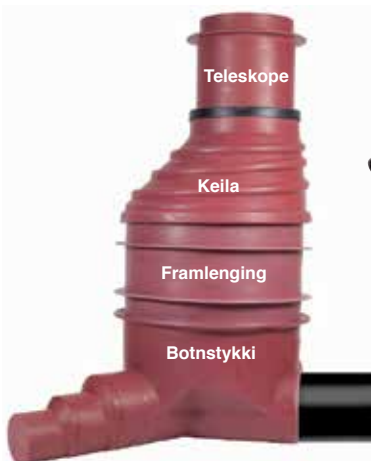
Brunnar \phi 1000 mm úttak allt að \phi 400 mm
