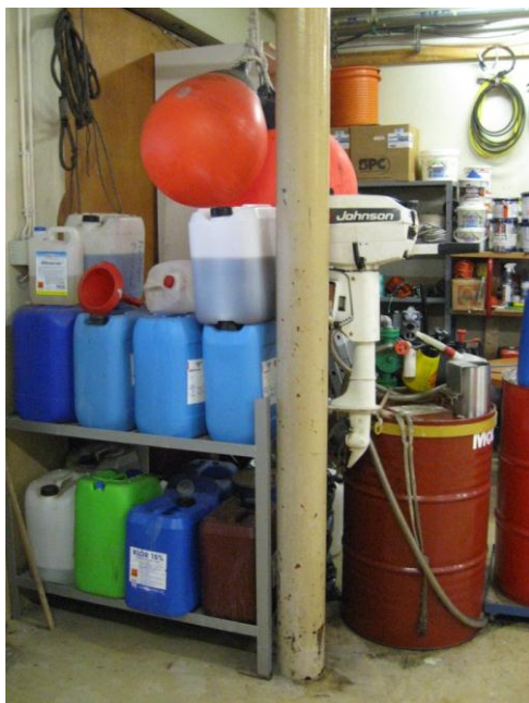
Mynd 9 Merkt efni, klór, álkloríð, frostlögur ekki geymd í lekabyttu.
