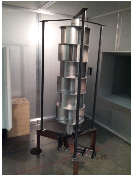
Mynd 5.1: Hér er búið að koma vindmyllunni fyrir í vindgöngum skólans.
