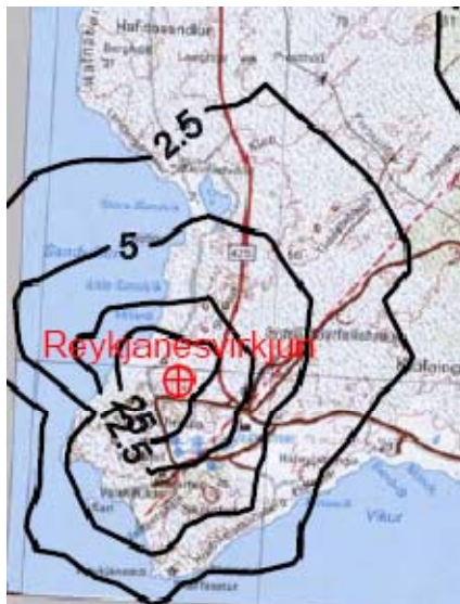
Mynd 28.3. Jafngildislinur sem sýna meðalstyrk brennisteinsvetnis ( \mu\text{g}/\text{m}^3 ) skv. loftdreifingarspá Verkfræðistofunnar Vatnaskila. Hæsta gildið sem þarna er sýnt, 25 \mu\text{g}/\text{m}^3 , samsvarar um 18 ppb eða 0,02 ppm, og er í næsta nágrenni virkjunarinnar.
