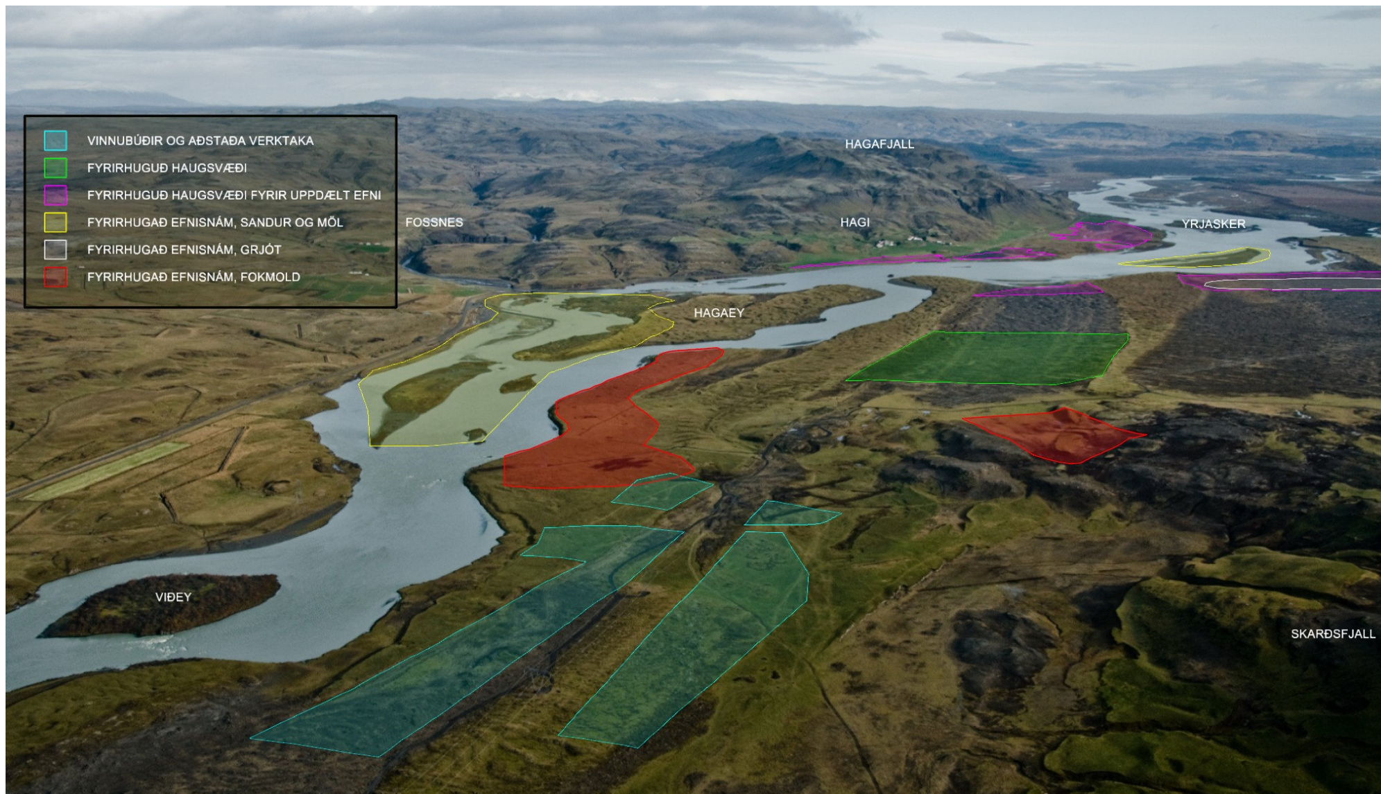
Mynd 5b. Horft í norður. Efnistaka, haugsetning, vinnubúðir og aðstaða verktaka eftir breytingar.
