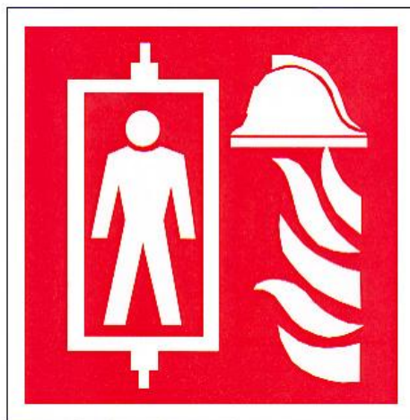
Mynd 5: Staðlað merki brunavarnarlyftu. Baklitur rauður, kantar og merki hvít.
