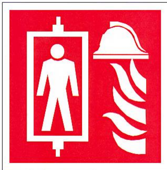
Mynd 6.8: Staðlað merki brunavarnarlyftu. Baklitur rauður, kantar og merki hvít.
