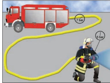
Mynd 5.10 Þrýstingstap verður í slöngum vegna rennslismótstöðu.
