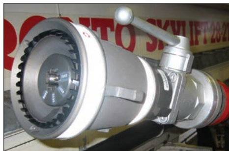
Mynd 5.70b Stútur með rennslisstíllplötu.
