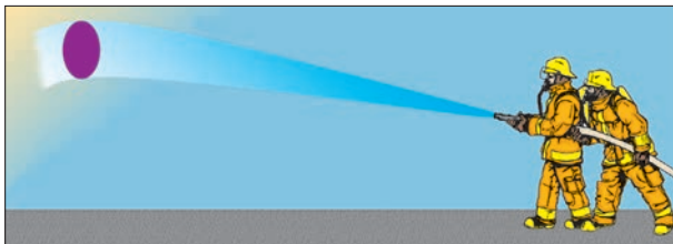
Mynd 5.65 Vatnsbuna sem brotnar í lokin og dreifist.
