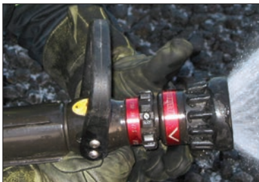
Mynd 5.69 Stútur með rennslisstilliskfu.
