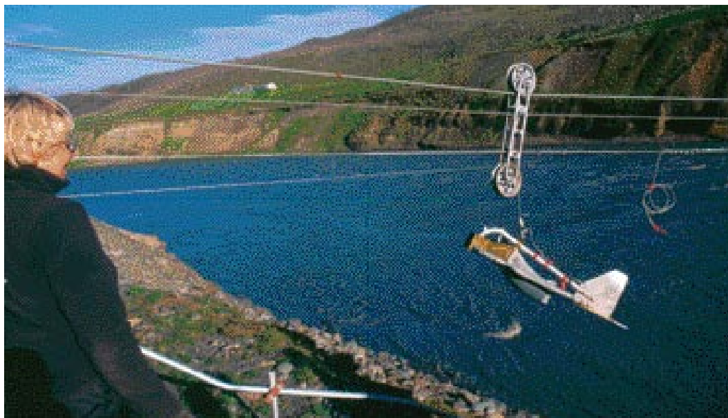
Unnið við botnskriðsmælingar við Jökulsá á Dal. Ljósmynd Oddur Sigurðsson.
