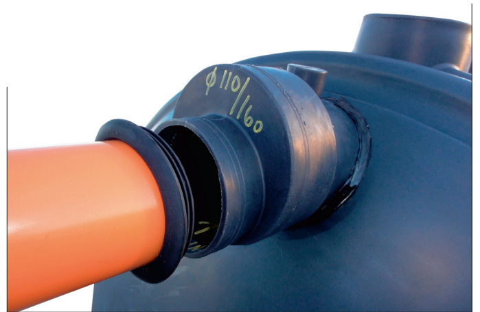
Valmöguleiki er að tengja Ø110 mm eða Ø160 mm rör í inntak og skal það þéttast með þar til gerðri gúmmipakkningu. Úttaksstútar eru Ø110 mm á minni þróum og Ø160 mm á 3600 ltr. og stærri. Útloftunar- og tæmingarrör Ø200 mm eru fánleg.
