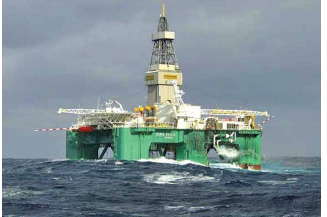
Eiríkur rauði, í eigu norska fyrirtækisins Ocean Rig ASA, er dæmi um hálfsvöðunlegan olíuborarpall sem hefur nauðsynlegan búnað til að vinna að borunum á norðanverðu Drekasvæðinu.
