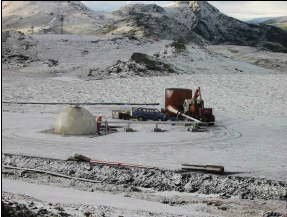
Mynd 21. Rannsóknahola HE-6 að lokinni borun með skýli og hljóðdeyfi.
