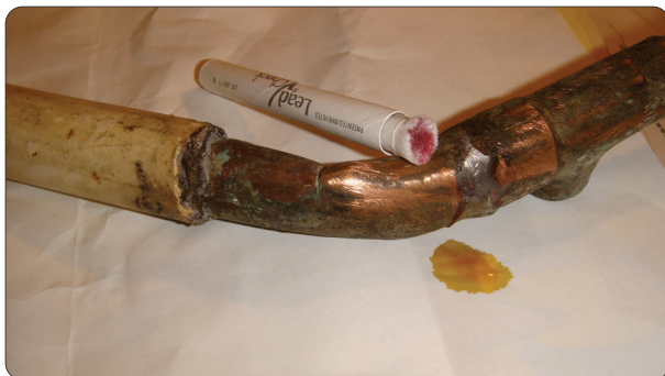
Mynd 1. Blýinnihald tins skoðað með LeadCheck® staut. Rauður litur gefur til kynna að tinið innihaldi blý. Ef ekkert blý hefur greinst í tininu, hefur hárin á stautnum verið gulleit, líkt og dropinn á blaðinu.
